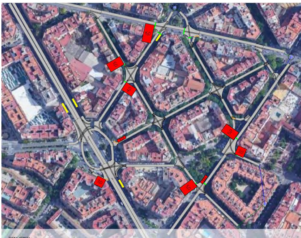
Ilustración 70: Colas de vehículos en las intersecciones de Arrancapins.
