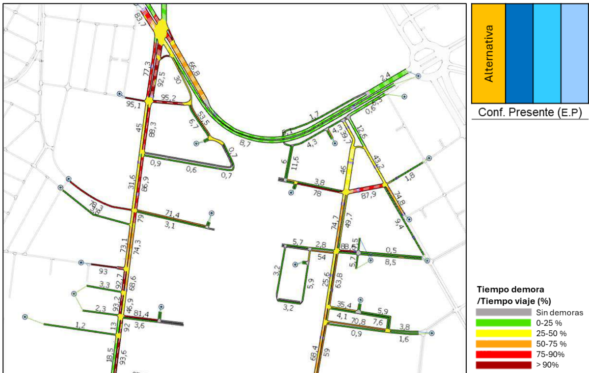
Figura 108. Tiempo demora / tiempo de viaje, configuración presente (E.P), matriz presente, zoom 1. Fuente: IDOM
