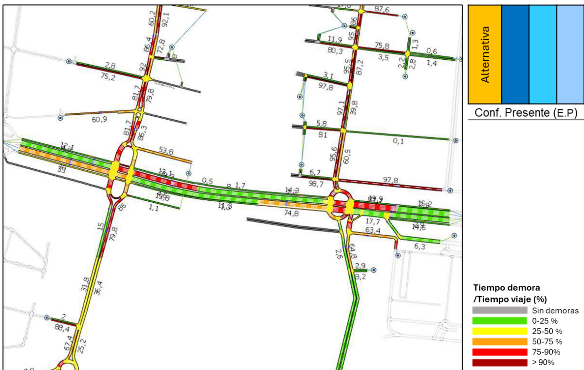
Figura 109. Tiempo demora / tiempo de viaje, configuración presente (E.P), matriz presente, zoom 2. Fuente: IDOM
