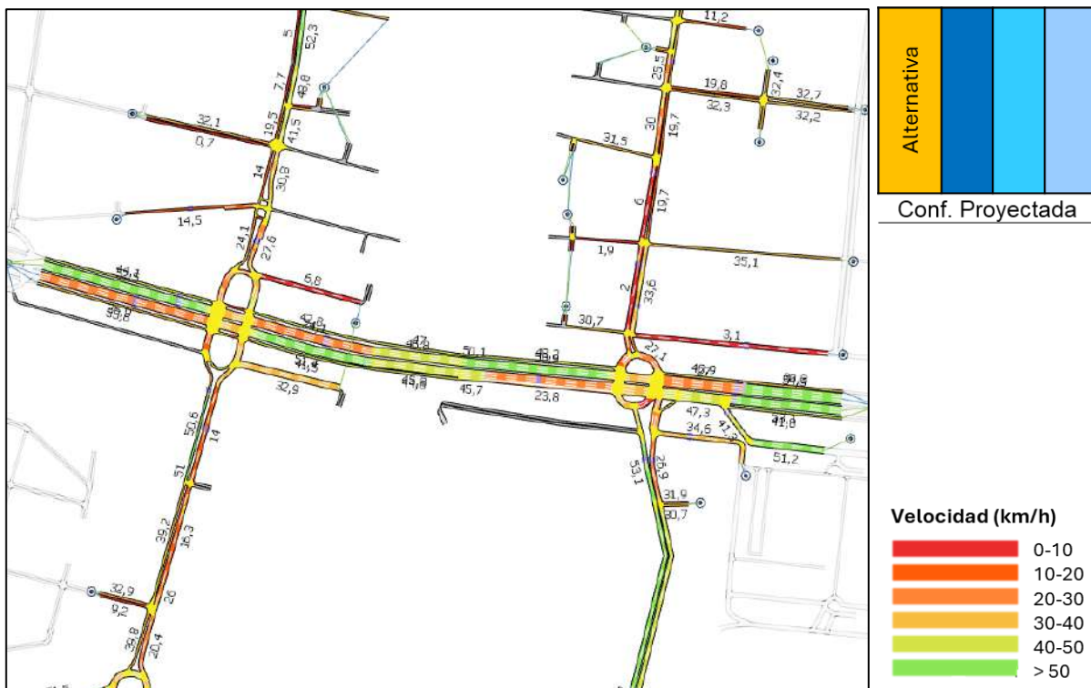
Figura 135. Velocidades, configuración proyectada en C/ San Vicente, matriz futura, zoom 2. Fuente: IDOM
