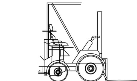
LOS VEHÍCULOS QUE NO TENGAN CABINAS CUBIERTAS PARA EL CONDUCTOR, DEBERÁN ESTAR PROVISTOS DE PÓRTICOS DE SEGURIDAD PARA CASO DE VUELCO.
