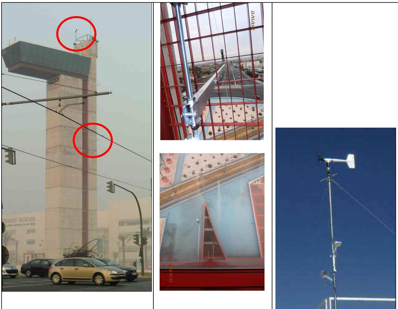
*Figura 11.1 montaje de la instrumentación colocada sobre la Torre de Miramar, en el que se ha resaltado el mástil meteorológico (detalle en la foto derecha) y una de las motas a una altura intermedia (detalle de la colocación en las fotos centrales).*
