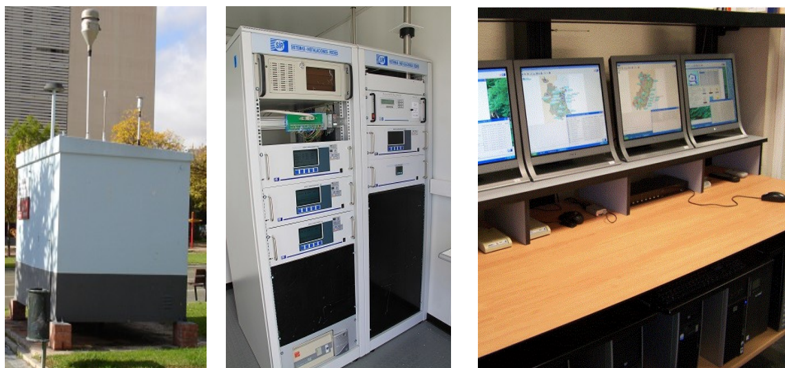
Figura 1. (Esquerra) Aspecte exterior d'una estació de qualitat de l'aire. (Centre) Monitors de
