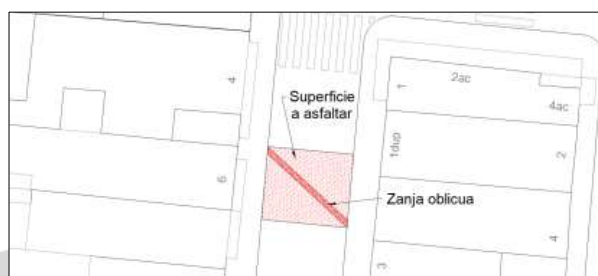
Figura 1. Afecció 1 carril. Superfície mínima a asfaltar.
