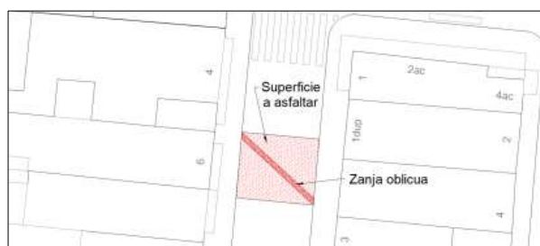
Figura 1. Afección 1 carril. Superficie mínima a asfaltar.
