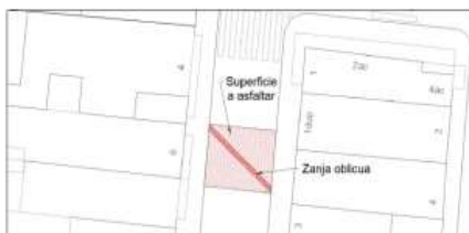
Figura 1. Afección 1 carril. Superficie mínima a asfaltar.
