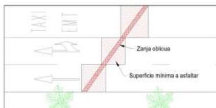
Figura 2. Afección varios carriles. Superficie mínima.
