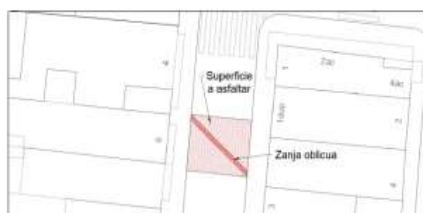
Figura 1. Afección 1 carril. Superficie mínima a asfaltar.
