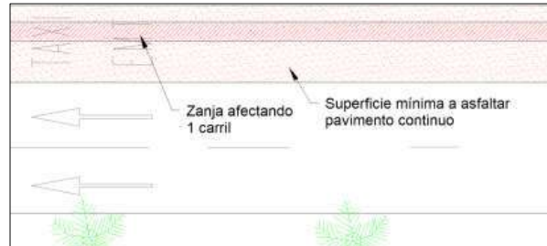
Figura 4. Afección 1 carril. Superficie a reasfaltar.
