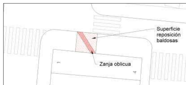
Figura 6. Superficie reposición baldosas en zanja oblicua.
