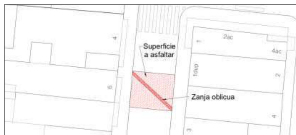
Figura 1. Afección 1 carril. Superficie mínima a asfaltar.
