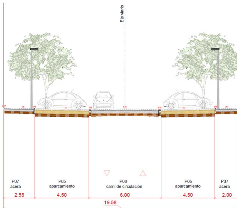
Figura 16 Sección Vial 01. Calle A
