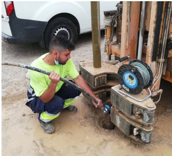
Ejemplo de ensayo de permeabilidad Lefranc realizado por SIGMA SL
