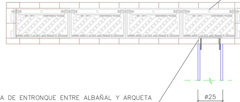
PIEZA DE ENTRONQUE ENTRE ALBAÑAL Y ARQUETA ADAPTADOR CLAPETA BN 250
