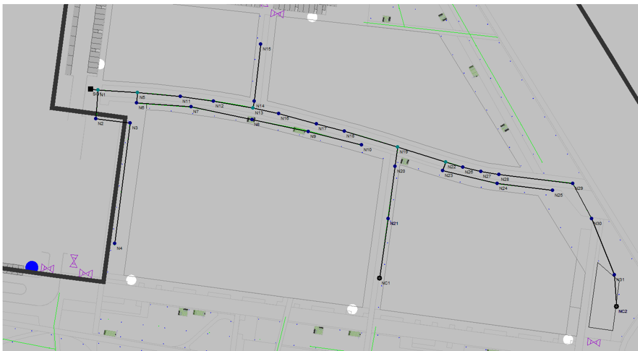
Figura 43 Modelo Red Riego en bocas en sector SCFA.
