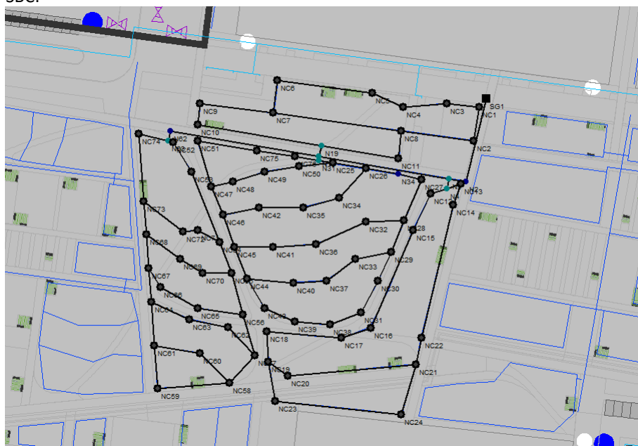
Figura 33 Modelo Red Riego en aspersión en sector SBC.
