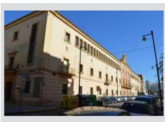
Se calcula una demanda energética de 181,67 kWh/m<sup>2</sup>año, mientras la normativa pide 86,55 kWh/m<sup>2</sup>año para rehabilitación. En el caso de ser algo más ambicioso que la normativa y reducir la demanda un 25% más, e incluyendo la instalación de energías renovables para ACS, una rehabilitación energética costaría unos 29€/m<sup>2</sup> de edificio.
