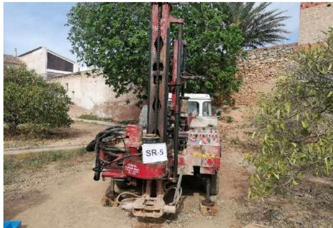
Fotografía 29: Vista de la maquinaria emplazada para el sondeo S-5.
