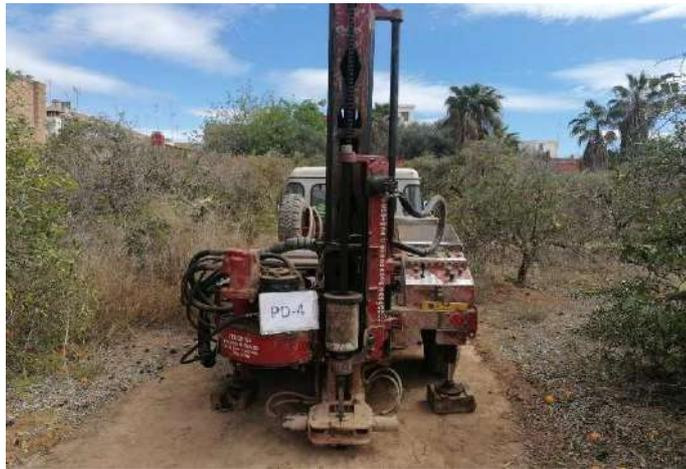
Fotografía 23: Vista de la maquinaria emplazada para la penetración dinámica PD-4.
