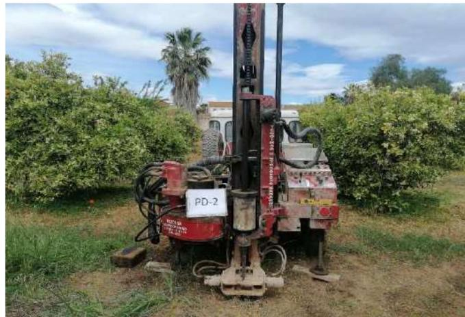
Fotografía 21: Vista de la maquinaria emplazada para la penetración dinámica PD-2.
