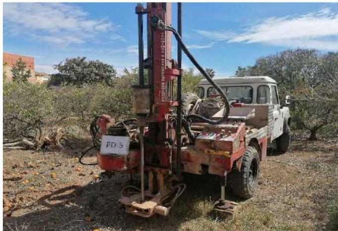
Fotografía 24: Vista de la maquinaria emplazada para la penetración dinámica PD-5.
