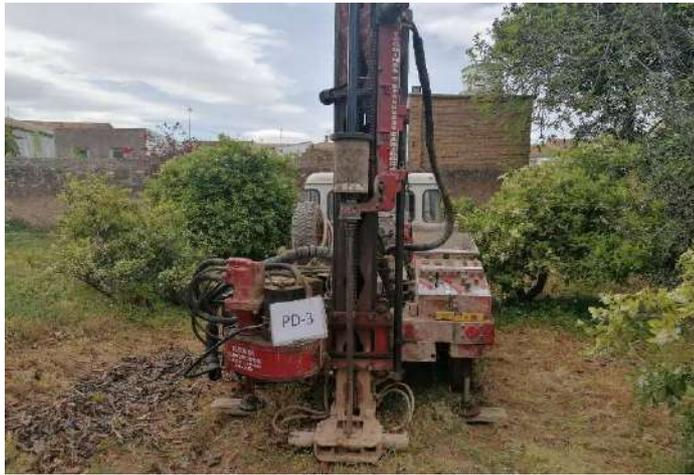
Fotografía 22: Vista de la maquinaria emplazada para la penetración dinámica PD-3.
