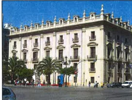
Estructura Portante: Muros de carga de fábrica de ladrillo macizo sobre zócalo de piedra.
