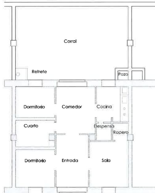
La barriada obrera objeto de este informe, constaba de 34 casas de las cuales quedan 18 según planos catastrales. De planta baja, con dos dormitorios, dos salas, un comedor, una cocina, excusado, pozo y corral. La fachada es de 9.10m y 4m de altura. La planta tiene un total de 120 m<sup>2</sup> aproximadamente. La construcción, de piedra y ladrillo con azulejos en el interior, es fuerte y resistente.
