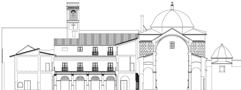
Alzado C/San Vicente; Sección por la iglesia y el monasterio paralela a la C/San Vicente [e 1/500]
