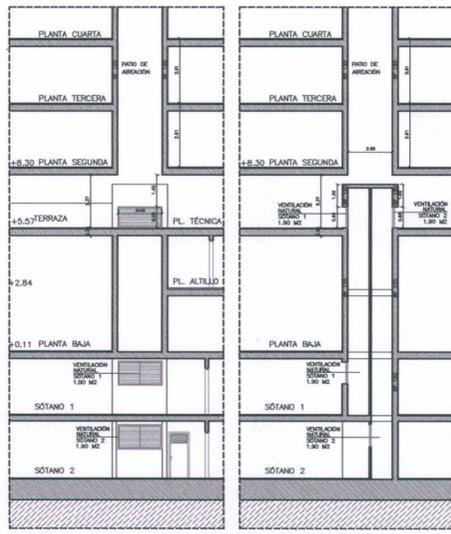
ESQUEMA SECCION VENTILACIÓN SÓTANOS
